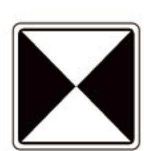
此图标所指示的零件对侧相同制作。
