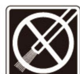
此图标所指示的零件不涂胶水。
